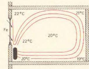
Konvektion der Luft in einem Raum durch einen Heizkörper
