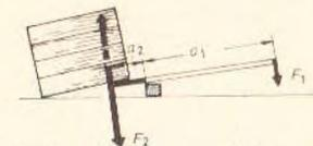
Kräfte und Hebelarme am Hebel
