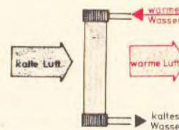
Prinzip des Wärmetauschers (Konvektion von Flüssigkeiten und Gasen)
