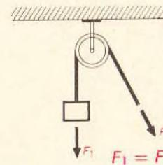
Durch die feste Rolle wird die Kraft umgelenkt ( $F_1 = F_2$ ).
