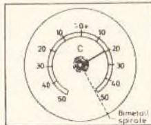
In der Technik findet man häufig das Bimetallthermometer, bei dem die unterschiedliche Wärmedehnung verschiedener Metalle zur Temperaturmessung ausgenutzt wird.
