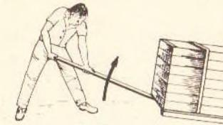
Durch den Hebel wird Kraft gespart
