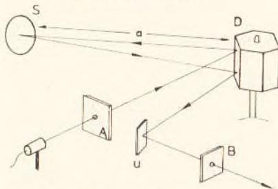
Versuch zur Messung der Lichtgeschwindigkeit nach Foucault-Michelson (1850). Beim Drehen des achteckigen Drehspiegels fällt das Licht nicht durch B. Erst wenn er sich so schnell dreht, daß er sich in derselben Zeit um  $45^\circ$  gedreht hat, wie das Licht für die Strecke  $2a$  benötigt, dann kann der Lichtstrahl erkannt werden. Bei einer sehr langen Strecke  $a$  konnte die Lichtgeschwindigkeit sehr genau ermittelt werden ( $\pm 4 \frac{\text{km}}{\text{s}}$ ).
