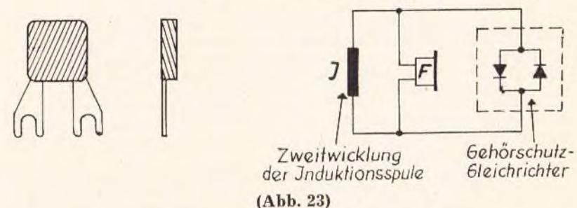
**Knallgeräuschen schützen.** Die Eigenschaft der Gleichrichter, auch in Durchlaßrichtung bei geringer Spannung einen großen Widerstand zu bilden, wird hier ausgenutzt.
