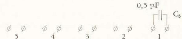
Zum Nachsetzen der Kondensatoren  $C_5$  (0,5  $\mu$ F) für die Hauptanschlußleitungen 2 bis 5.
