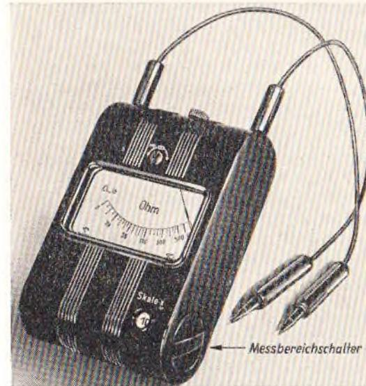
Bild 70. Widerstandsmesser „Triohm“ (Leitungsprüfer) von Gossen.
