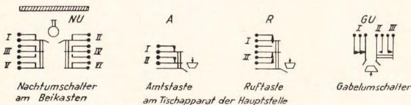
Bild 182. Zählweise der Schalterkontakte NU, A, R und GU.
