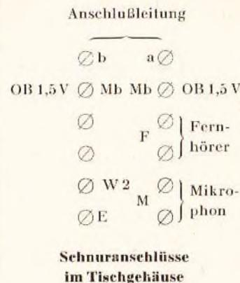
Schnuranschlüsse im Tischgehäuse
