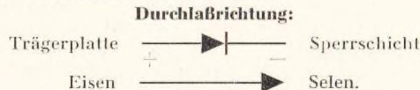
Der Widerstand des Gleichrichters kann bei kleinen Spannungen in der Sperrichtung 8000 mal so groß sein wie in der Durchlaßrichtung.
