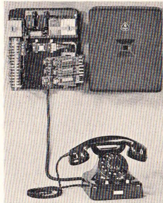
Bild 175. Beikasten geöffnet. Relaisrahmen herausgeschwenkt. Tischapparat mit Amtstaste (rot) und Ruf-taste (weiß); die Tasten sind nichtsperrend und werden zur Betätigung nur kurz gedrückt. (Vgl. Schaltung Bild 181.)
